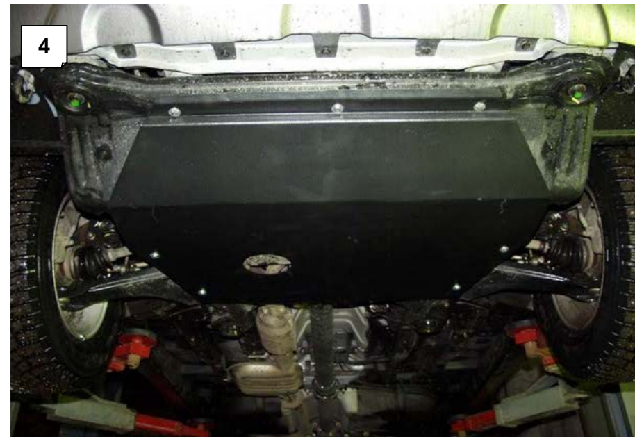
Bei Verletzung der Kunststoffbeschichtung durch Fremdeinwirkung, Oberflächenbeschichtung wiederherstellen (z.B. mit Unterbodenschutz streichen)
