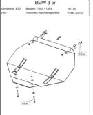
Die Einsteckschraube und Schraube M10x65 durch die Bohrungen am Rahmenträger des Kühlers hinstellen.
